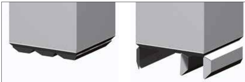
Bodemkleppen 3 fractie glas, alleen mogelijk bij driehaaks opnamesysteem.
