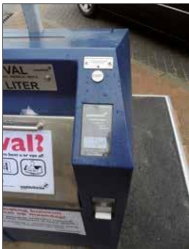
Toegangscontrole met muntautomaat op een ondergrondse container (Gemeente Middelkerke, BE).
