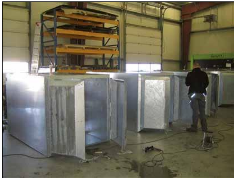
Afmonteren van de bodemkleppen.
