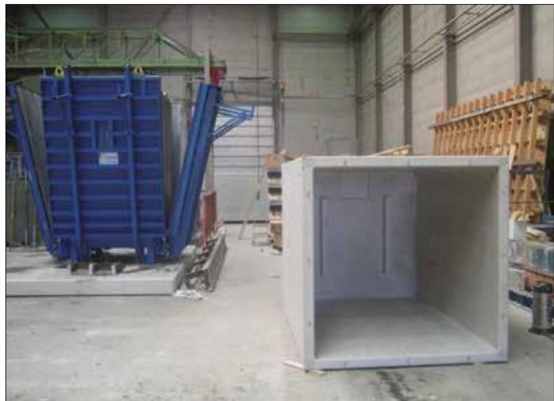
Er wordt altijd gebruik gemaakt van een 5000 liter put (4000 liter op aanvraag). De containersteun is in de bodem geïntegreerd en via de verdiepte opening wordt eventueel water weggezogen.
