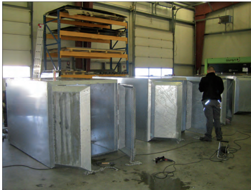
Afmonteren van de bodemkleppen.
