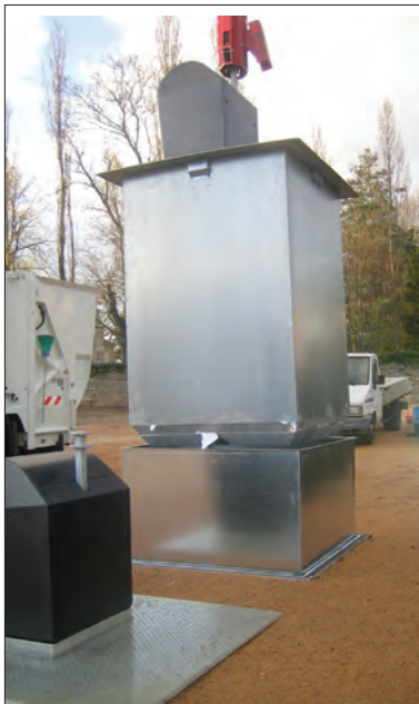
Zodra de container opgetild wordt, verschijnt de veiligheidsvoorziening.
