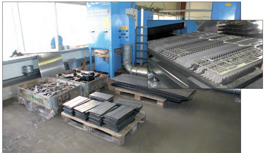
Onderdelen worden met de laser gesneden. Snel en modern.
