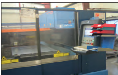
CAM snijdt de tekening in staal zonder mal en instelkosten.
